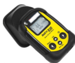
(表面汚染検査計の例)
